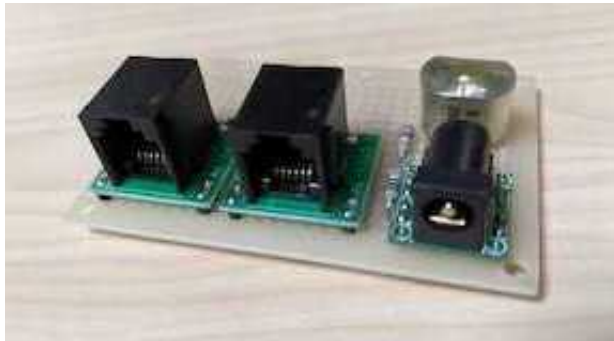
▲ 図 6.4 ユニバーサル基盤で作成した inducer
