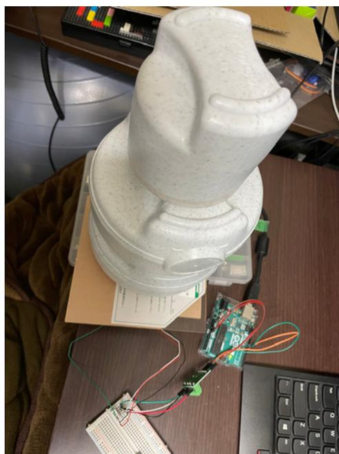
▲図 3.9 6kg の荷重を加えている様子
