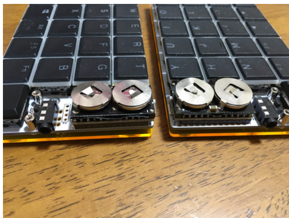
▲図 5.2 BLE Micro Pro と電池基板の実装
