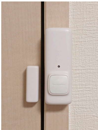
▲図 1.2 SwitchBot 開閉センサー：2 つのパーツに分かれており、ドアとドア枠に設置します
